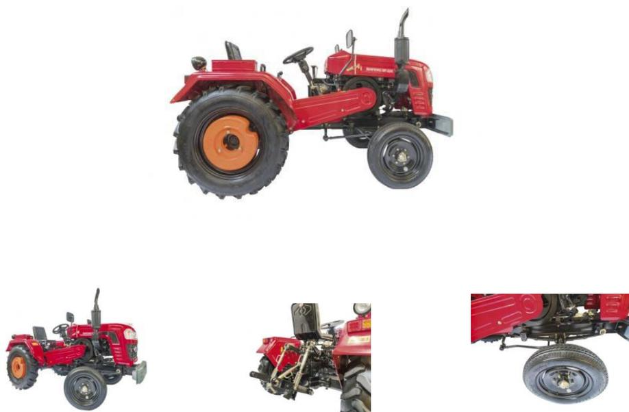
Трактор SHIFENG SF-220 — это недорогая сельскохозяйственная машина с техническими характеристиками полноценного трактора. Завод-изготовитель запатентовал рамную конструкцию трактора с установленным на него дизельным двигателем с водяным охлаждением, и ремённым приводом на КПП (3+1)x2, с трехточечной системой навесного оборудования и валом отбора мощности 720 об/мин.
