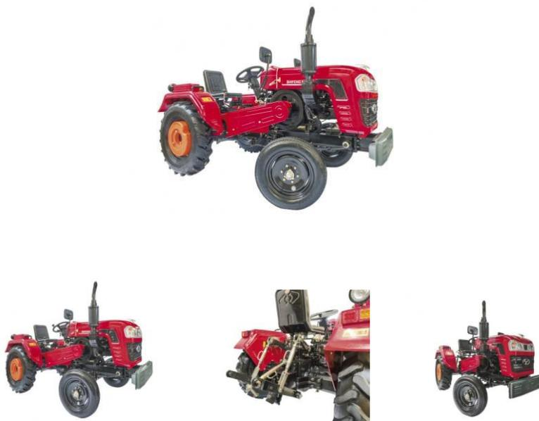
Shifeng SF-240 — это заднеприводная сельскохозяйственная машина на базе рамного шасси с ременным приводом от одноцилиндрового двигателя мощностью 24 л.с.
